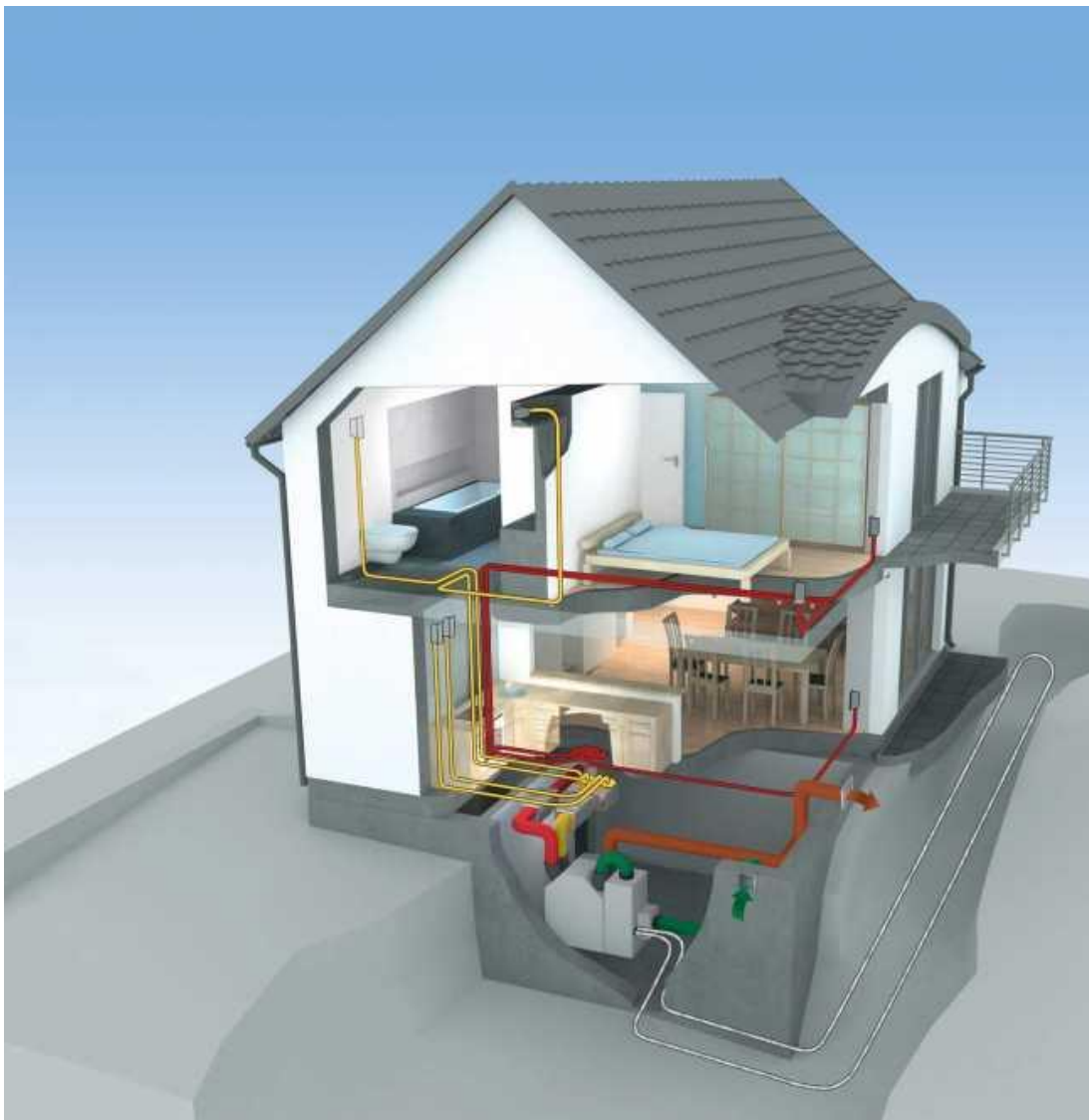
Obr. 7 Kvapalinový soľankový zemný výmenník tepla Zehnder ComfoFond-L s dĺžkou potrubia do 60 m. Vďaka jednoduchej inštalácii zemného výmenníka pred vetracou jednotku je ideálnym riešením na zvýšenie komfortu ochladením vzduchu v lete a predhriatie vzduchu v zime, ako do rodinných a bytových domov, tak aj nehnuteľností so spodnou vodou
