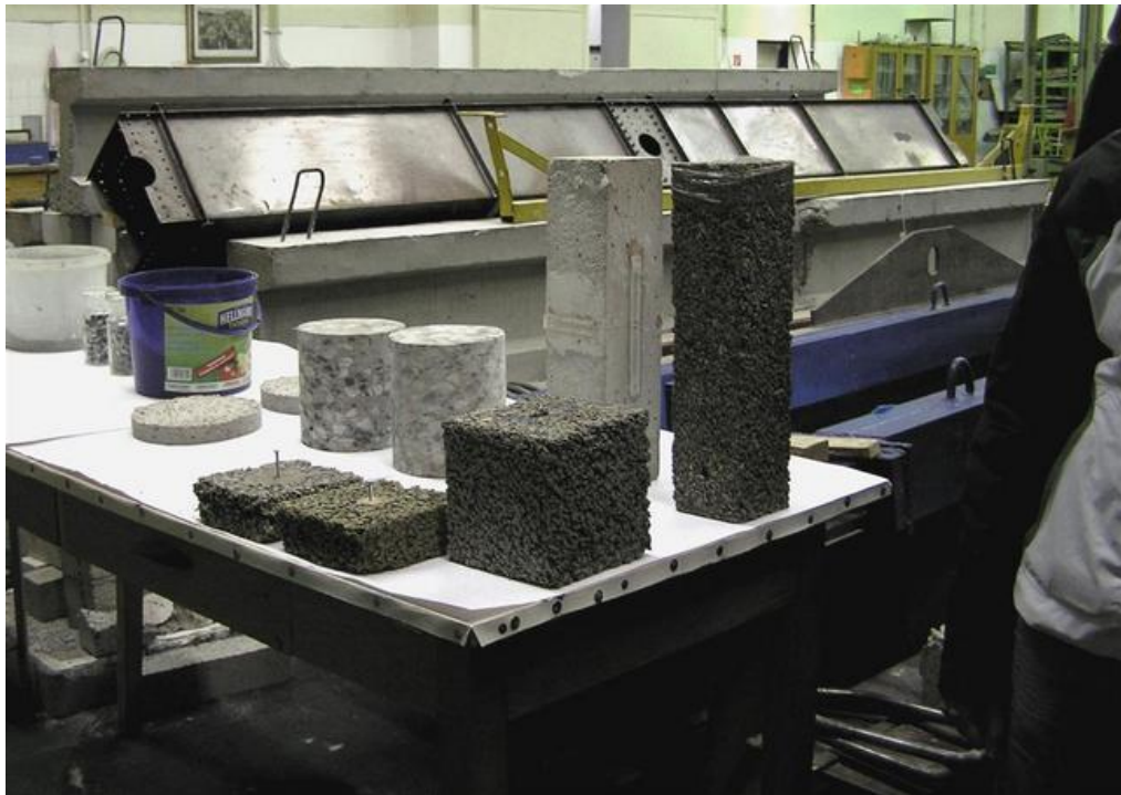
Experimentálne riešenia betónu s prímiesami dreva a drevotriesky. (zdroj: archív Ivica Jakobovičovej)
